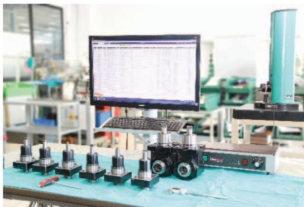
*A sinistra: postazione di montaggio. Gli operatori del montaggio possono consultare direttamente le procedure e le distinte base di montaggio a video*
