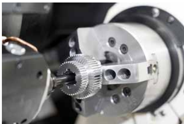
Lavorazione della sede di una chiavetta con il modulo brocciatore motorizzato di M.T.
